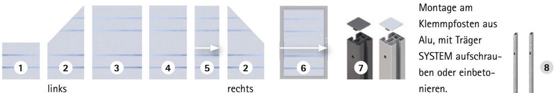
Montage am Klemmpfosten aus Alu, mit Träger SYSTEM aufschrauben oder einbetonieren.
